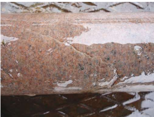
Рис. 3. Гранитный керн с макротрещиной по скважине № 7
